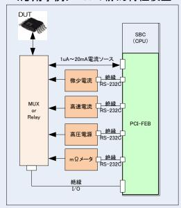
パス設定→RS-232Cで電源制御→DUTへ電流・電圧を 特徴 印加→測定/サンプリングをPCI-FEB1台で可能。 複数使用して並列測定も可能です。
